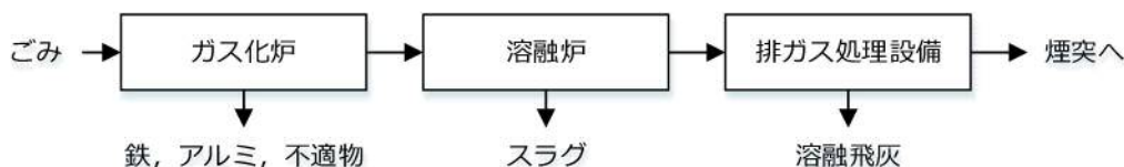
図 10-1 次期ごみ処理施設で発生する残渣
