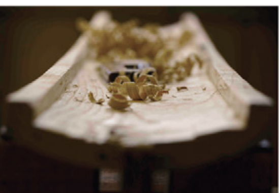
琴の音の質は甲と裏板の間のできる空間が全て。甲の裏側はくぼみがないようカンナで削る
