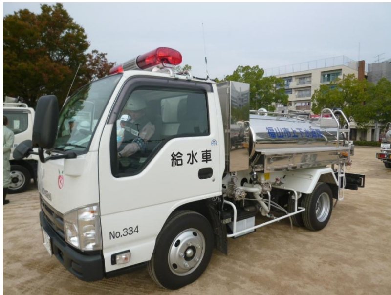
給水車（容量2 m 3 ，加圧ポンプ機能搭載）
