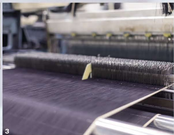
1.織られる前のインディゴ染めされたタテ糸 2.織り機にセットする前のヨコ糸の準備 3.タテ糸にヨコ糸を打ち込みデニムに織り上げていく 4.織り上がったデニムは全て目視で検査
