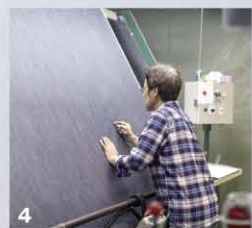
1.織られる前のインディゴ染めされたタテ糸 2.織り機にセットする前のヨコ糸の準備 3.タテ糸にヨコ糸を打ち込みデニムに織り上げていく 4.織り上がったデニムは全て目視で検査
