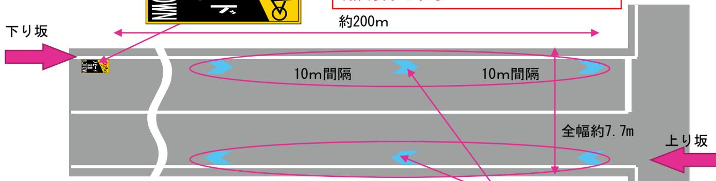
※矢羽根の段差を避けるため、車道中央側を走行するのを防ぐため、矢羽根は外側線から15cm程度離して設置する。
