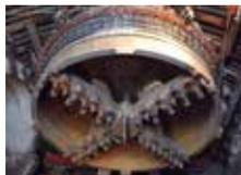
掘削機械 (シールドマシン)
