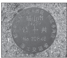
街区基準点 (街区多角点) 図の種類が違い課題もありそれらの整理も含め占有者と協議する。
