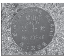
街区基準点 (街区多角点)
