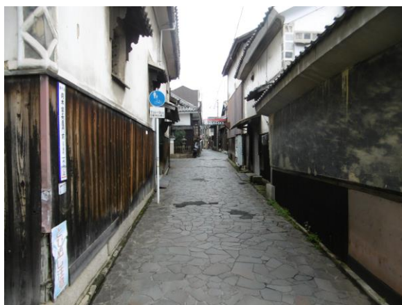
路地を挟んで建ち並ぶ伝統的建造物(建築物)。土蔵造りは防火帯の役割を担う
