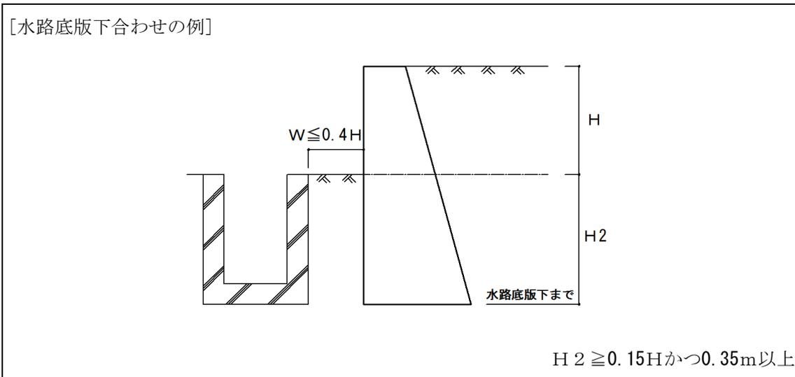
(2) 擁壁と水路の距離 (W) が [擁壁の高さ (H) × 0.4] m を超える場合
