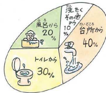
せいかつはいすい げんん わりあい 生活排水のよごれの原因の割合
