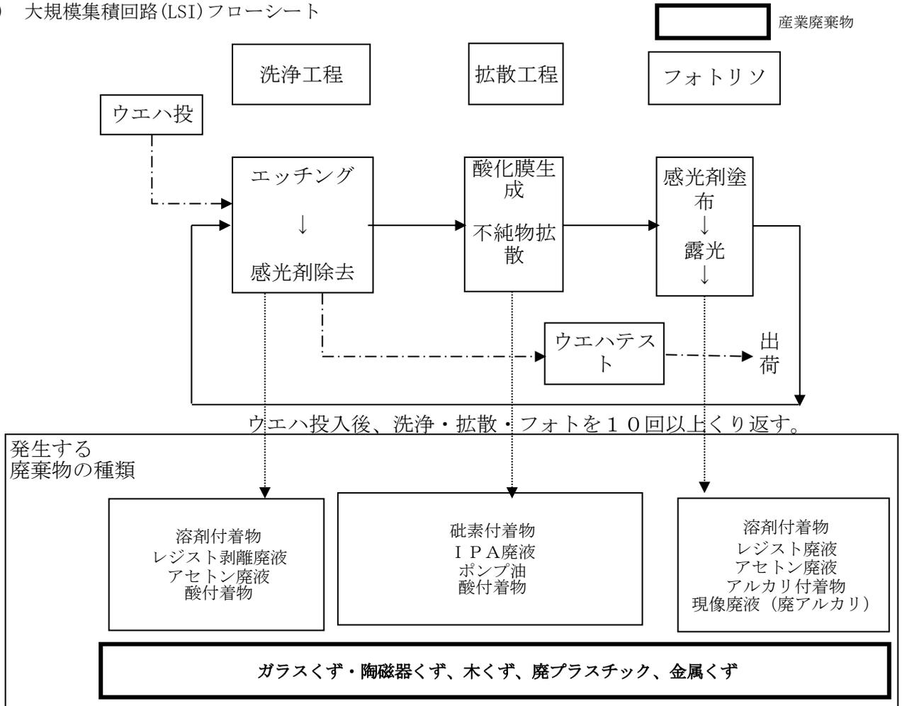
(図2) 半導体レーザー製造フローシート
