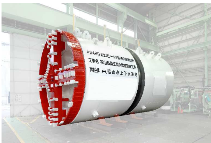
「地下を掘り進める機械（シールド機）」
