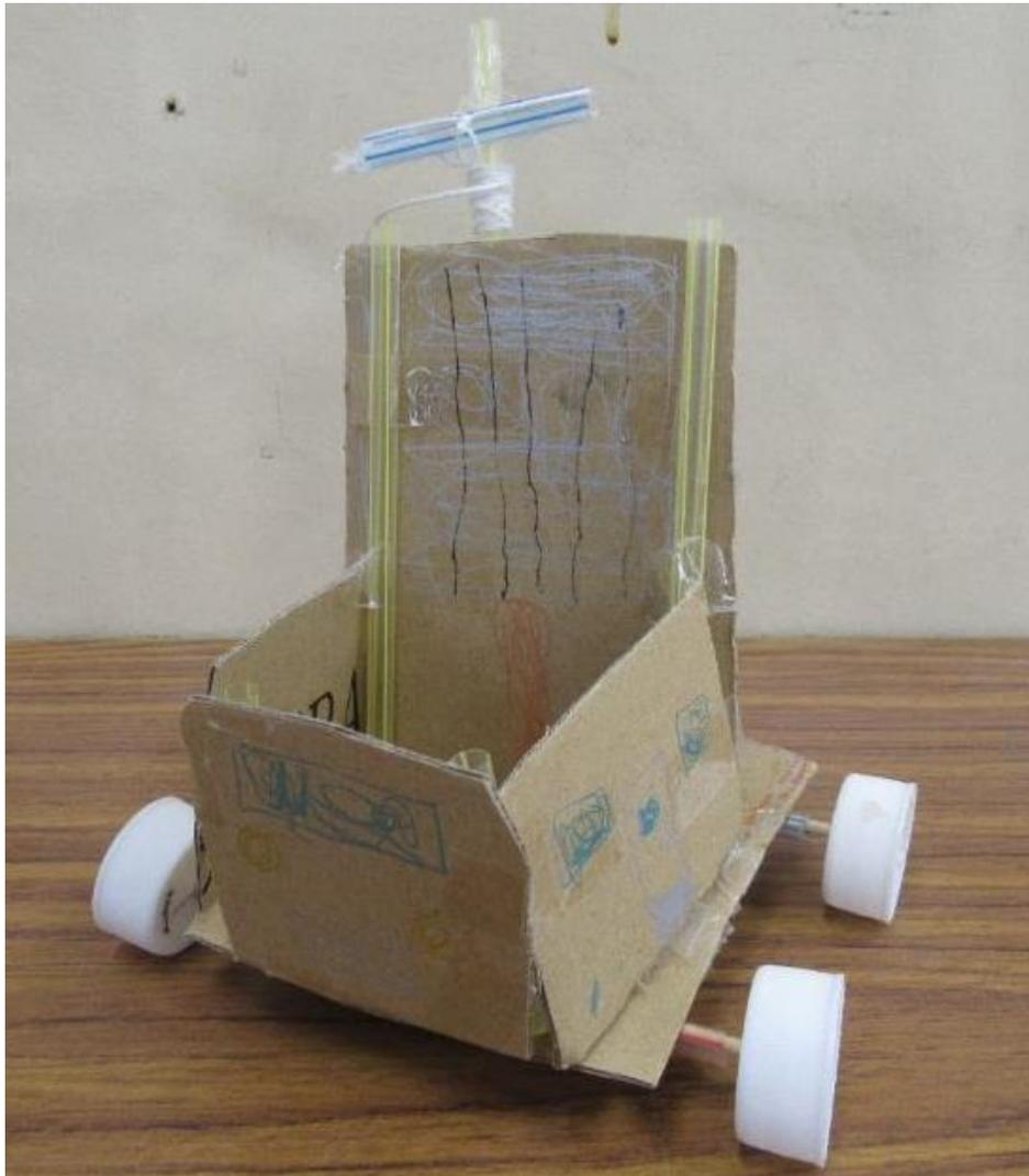
風で動く車を作りました。タイヤを作るときに、キャップの中心に穴をあけるのが難しかったです。安定させるために、ストローで骨組みを作る工夫をしました。
