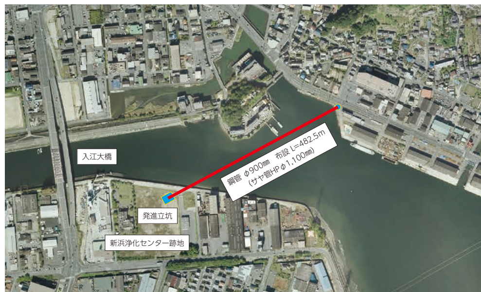
海底管推進工事概要
