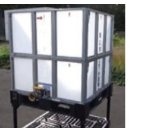
仮設水槽 (容量:1m 3 )
