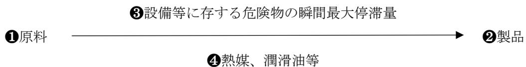
上記の製造所の取扱量は、①+④、②+④又は③+④のいずれかとなる。
