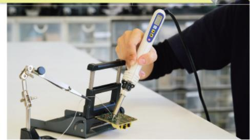
電子工作にぴったりの商品が認定されました。グリップ部分に温度表示のための液晶ディスプレイを搭載したはんだこてです。ハンディータイプでデジタル制御・デジタル表示ができる商品は、国内メーカー初の取り組み。こて先の温度は200度~500度まで1度単位で調節することができます。
