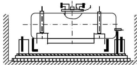
③支柱4本を立て、アンカーボルトで固定する。
