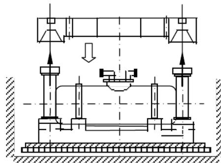
⑤コンクリートパーツの隙間にはモルタルをつめ、検知管やプロテクターを所定の位置に取付け、配管セットを接続する。
