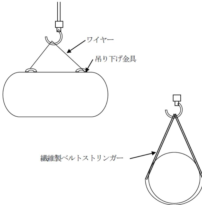
別図-2 (その1) 吊り下げ作業法の例
