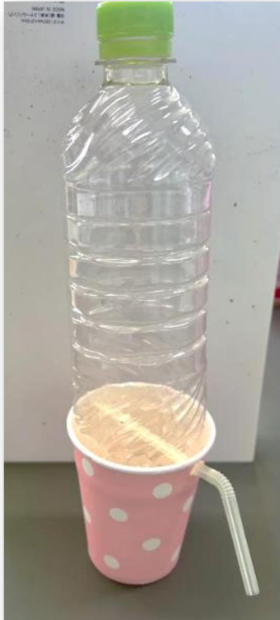
ペットボトルと紙コップ、ストローを使い、空気と水の性質を生かしてウォーターサーバーを作りました。うまく水がでるように工夫しました。
