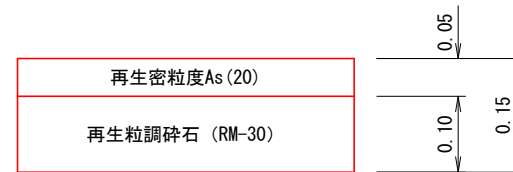
舗装復旧断面図 S=1:10
