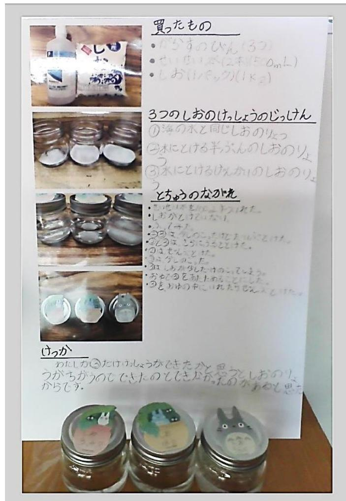
わたしは、しおのけっしょうのじっけんをしました。まず、材料を用意しました。材料は、塩、精製水、ガラスの瓶の3つです。塩をガラスの瓶に入れて、塩の量を変えて結晶ができるか実験しました。塩の量が多いと結晶ができやすいと分かりました。
