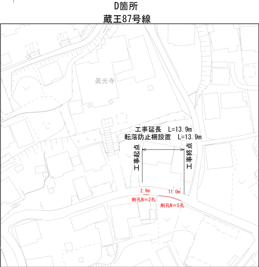
【通学路】転落防止柵設置L=13.9m、削孔N=7孔
