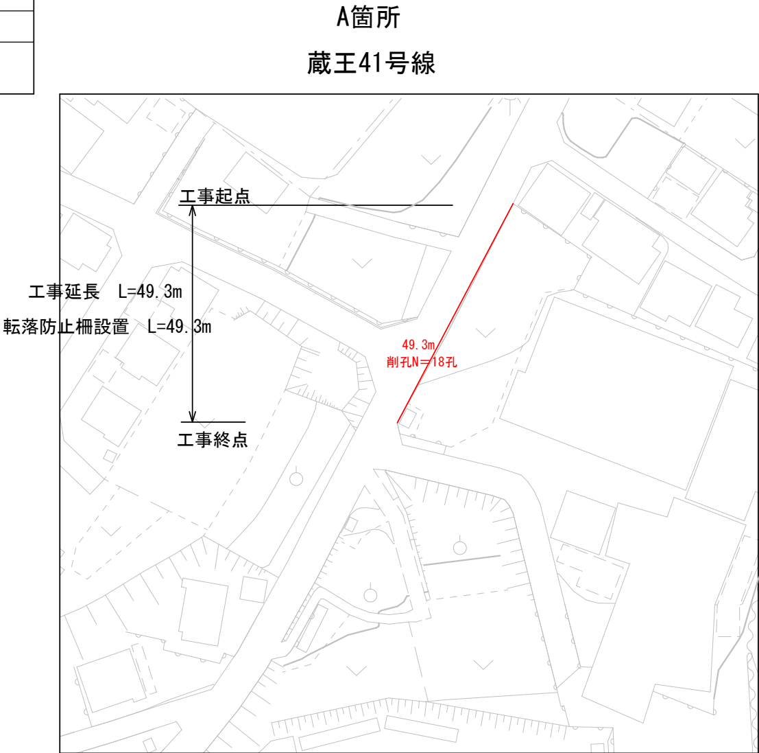
【通学路】転落防止柵設置L=49.3m、削孔N=18孔
