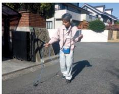
水道管がこわれて大切な水が無駄にならないように、漏水検知器や音聴棒を使って水もれを調べて、早めに修理をしています。最近はAIを活用した漏水調査も行っています。
