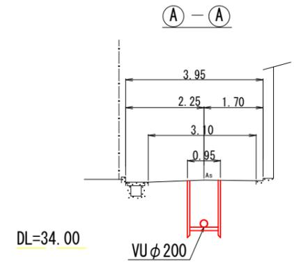
管渠埋設縦断面図 S=縦1/100 横1/500
