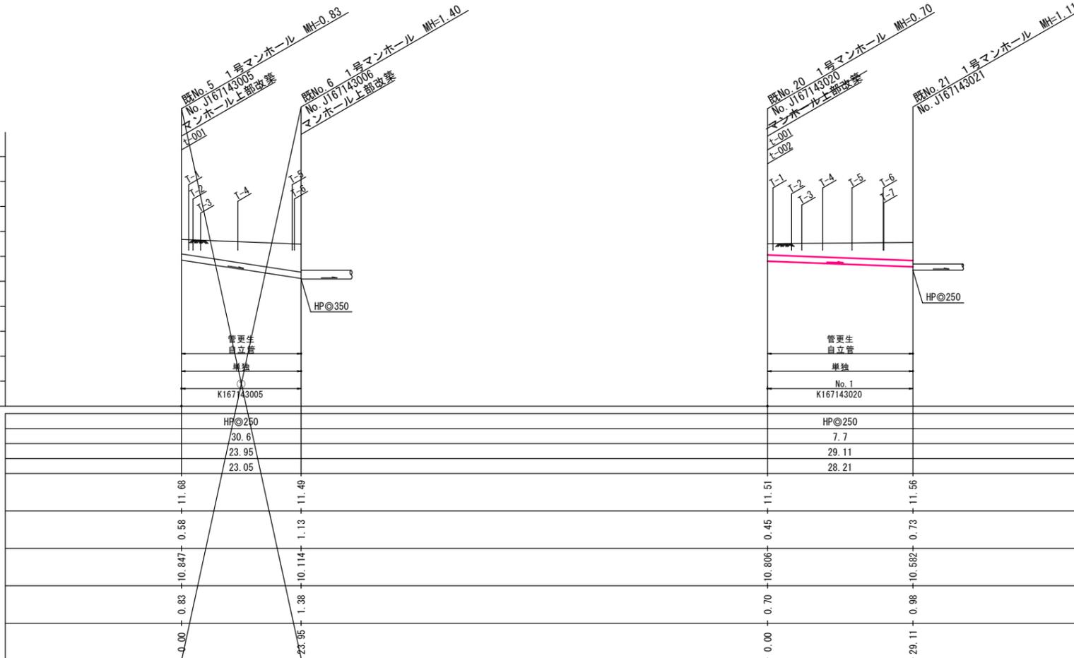
※取付管に、管径が表記されていないものはφ150とする。
