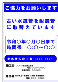
新路上工事看板（工事中表示板）
