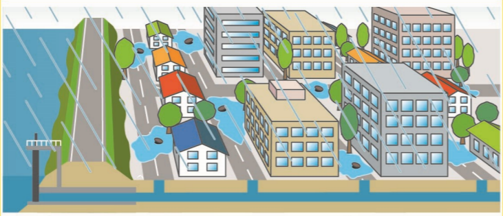
大雨が降ると、雨水が排水できなくなり、宅地や道路の浸水が発生します。
