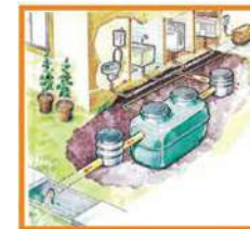
浄化槽 (出典：環境省『よりよい水環境のための浄化槽の自己管理マニュアル』より)
