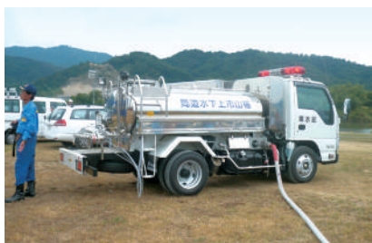
給水車(容量: 2m 3 )
