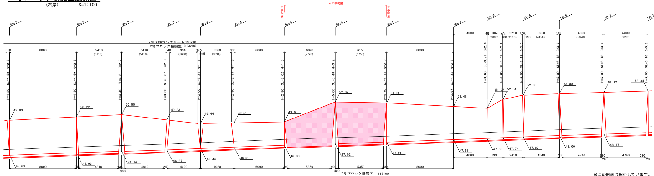
2号ブロック積擁壁展開図 (右岸) S=1:100
