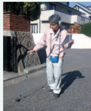
▲路面音聴調査の様子
