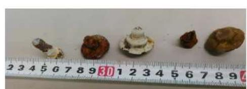
例：アンカーボルトが腐食により破断した事例
